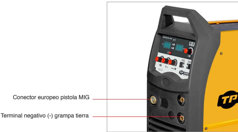
**ARCO MANUAL:** Conectar el cable del porta electrodo al terminal "+" (positivo), girarlo en sentido del reloj hasta que esté apretada.
